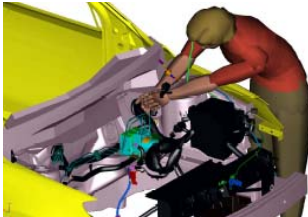
【エンジンルームのハーネスでの手作業イメージ】
